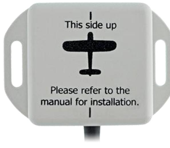
Der Kompass muss möglichst exakt mit dem Pfeil in Flugrichtung zeigen.
