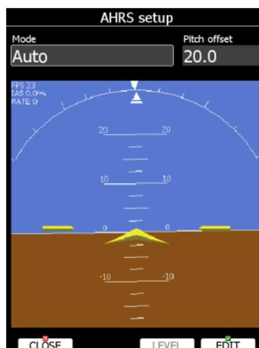
Bringen Sie Ihr Flugzeug in die nivellierte Position, die man auch bei der Wägung einnimmt (Wasserwaage mit Keil auf Rumpfrücken 1000:x. x ist dem Handbuch zu entnehmen.) und Flügel absolut waagrecht (ebenfalls mit Wasserwaage). Drücken Sie nun die Taste bei LEVEL. Sie können den Pitch verstellen, indem Sie den UP/DOWN-Drehschalter verwenden.
