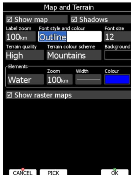
Mit dem UP/DOWN-Drehschalter (rechts unten) ändert man die Schriftart. Der entsprechende Text wird gleich in der passenden Schriftart dargestellt. Mit dem Zoom-Drehschalter (links unten) ändert man die Farbe der Schrift. Verwenden Sie den den Button PICK, um die Farbe feiner einzustellen. Ein Dialog wird geöffnet, in dem Sie die Farbe graphisch oder durch Eingabe der Komponenten (Rot, Grün, Blau) wählen können.
