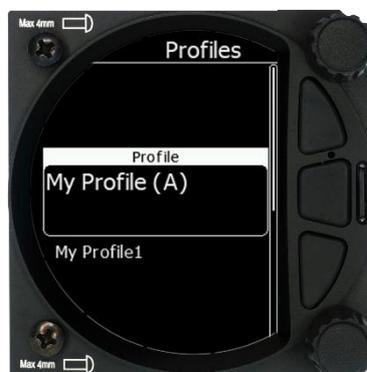
Mit dem unteren Kombischalter kann man durch die Profile blättern Auswahl mit Drücken. Die Profile werden im internen Speicher abgelegt. Wenn man ein Profil durch Drücken des unteren Kombischalters auswählt, bekommt man folgende Optionen:
