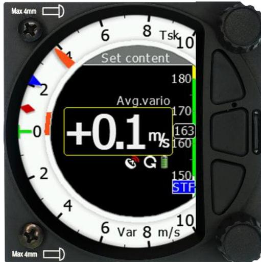
Diese Seite zeigt neben der Varioskala überwiegend numerische Daten. Es stehen vier Datenzeilen zur Verfügung, die jede mit verschiedenen Werten belegt werden kann, je ein Wert im Sollfahrtsmodus, einer im Variomodus. Die Varioskala wird gemäß den Einstellungen im Setup (Kapitel 5.7.3.8) skaliert. Drei Symbole auf der Skala geben einen schnellen Überblick auf wichtige Steigparameter oder andere Daten. Das Sollfahrtsymbol und weitere Statusanzeigen ergänzen den Datenumfang.
