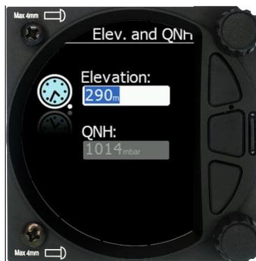
Das Gerät bietet die Höhe über der Standard QNE-Druckfläche an. Mit dem Drehschalter stellen Sie die Elevation des Startortes ein.
