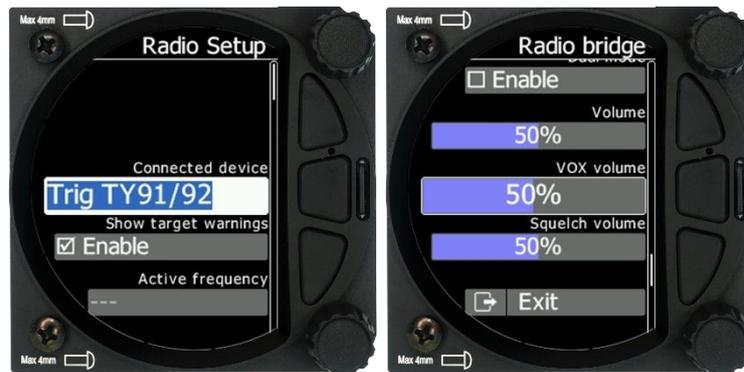
**Show target warnings** ermöglicht, dass Fehlermeldungen des Funkgerätes im S8x/S10x angezeigt werden. Einstellbar sind weiterhin **Active** und **standby Frequenz, Volume, Squelch Volume** und **VOX Volume**.
