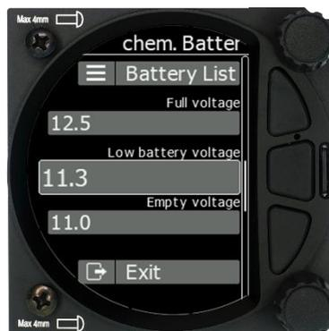
**Battery List:** In dieser Liste können Sie gängige Batterietypen auswählen, die Werte sind dann vorgegeben. Sie können das bei der Auswahl direkt überprüfen, die Werte werden in einem Dialog angezeigt.
