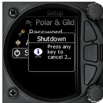
Lässt man vorher los, wird der Countdown abgebrochen, das Gerät bleibt an.
