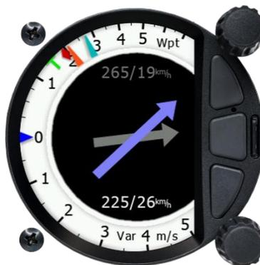
Bei Verwendung der HAWK-Option ist die durchschnittliche Standardzeit für Wind auf 30 Sekunden eingestellt. Sie können diesen Wert im Menüpunkt **Setup ->Vario parameters** ändern. Wenn die HAWK-Option nicht verwendet wird, ist die Mittelungszeit auf drei Minuten festgelegt. Weitere Informationen zu HAWK finden Sie in Kapitel 7.
