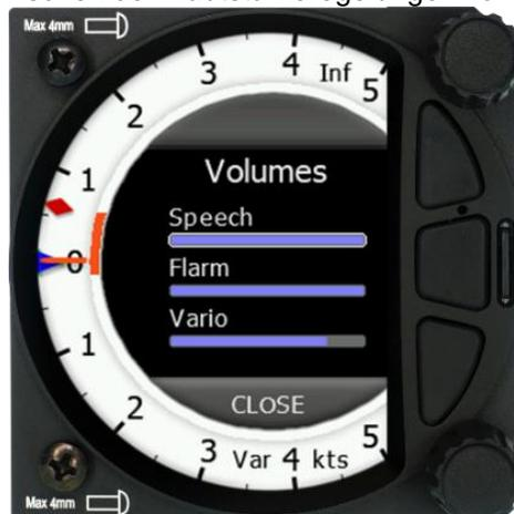
Prinzipiell wird der untere Drehschalter zur Eingabe von Werten im aktuellen Modus/Menü verwendet
