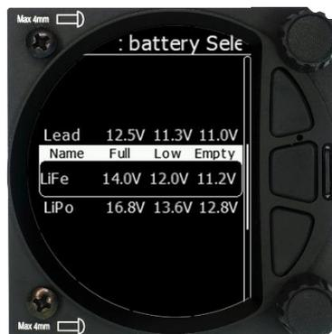
Ist Ihre Batterie nicht dabei (z.B. Nickel Metallhydrid NiMH), können Sie maximale Spannung, Warnschwelle und Abschaltspannung (Empty voltage) manuell definieren
