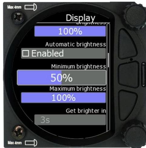
Mit der Drucktasterfunktion des unteren Kombischalters aktiviert man den Regler. Durch Drehen verändert man den Wert und bestätigt wieder durch Drücken.
