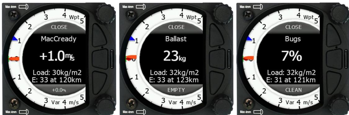
Um den MacCready Wert einzustellen, drücken Sie kurz auf den unteren Kombischalter (Druck/Dreh) und wählen Sie aus der angebotenen Menüliste MC/BAL. Ein weiterer kurzer Druck bringt Sie zur Ballasteinstellung und dann weiter zum Bugs Menü (Mücken). Die Werte werden durch Drehen am unteren Kombischalter eingestellt. Nimmt man für mehr als 3 Sekunden keine Eingabe vor, so wird das Menü automatisch verlassen. Ebenso kann man jederzeit CLOSE verwenden (oberster Drucktaster).
