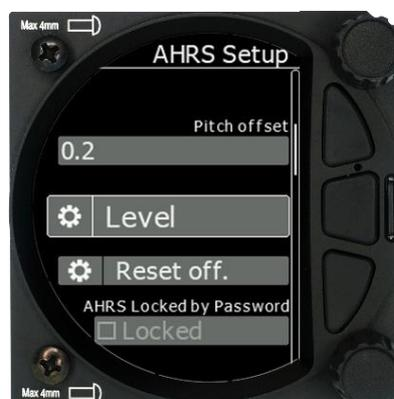
**Reset off.** Die Taste setzt den System-Pitch-Offset und den Benutzer-Pitch-Offset auf Null zurück (Werkseinstellung).
