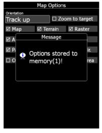
Premendo il pulsante **MEM1** per un tempo lungo verrà visualizzato il messaggio "*Opzione memorizzata nella memoria 1*" e l'impostazione sarà memorizzata. Analogamente per la
