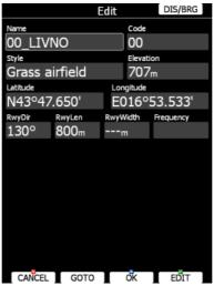
Esistono due possibilita' per introdurre una posizione. Puoi modificare latitudine e longitudine per definire la posizione del puntooppure premi il tasto **DIS/BRG** per introdurre distanza e direzione da un punto a scelta.
