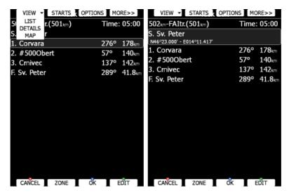
Premi **VIEW** per scambiare le viste lista e lista dettagliata. In modo lista dettagliata sono mostrate anche Latitudine e Longitudine. Premendo ancora **VIEW** si entra nel modo editor di Mappa.
