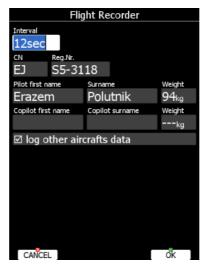
Selezionare l'intervallo di registrazione ed immettere il nome del pilota. Il peso del pilota, è importante se il ballast è in kg. (vedi capitolo 6.1.11). Se il sistema è usato in un mezzo biposto, si può inserire anche il nome del copilota.
