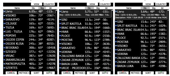
Premere **VEDI** per cambiare i dettagli dell'aeroporto selezionato. Premere **SORT** per cambiare l'ordine con cui sono mostrati. Selezionare un aeroporto usando il selettore di Pagina. Premere **GOTO** per navigare verso il punto scelto.
