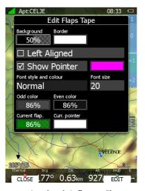
Il puntatore Magenta mostra la posizione ottimale dei flaps. Il puntatore bianco mostra la posizione attuale dei flaps. La banda delle velocita' indicate per la attuale posizione dei flaps e' colorata di verde. Quando e' scelta una posizione errata di flaps, la banda diventera' rossa.
