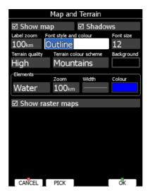
Ruotare la manopola in basso a destra (selettore pagine) per cambiare stile del carattere. Il testo sarà presentato nello stile selezionato. Ruotare la manopola in basso a sinistra (zoom) per cambiare colore. Premere il bottone **PICK** per definire il colore con precisione. Si aprira' un dialogo di scelta del colore: scegli il colore desiderato nel cerchio HSV oppure introduci un valore di rosso, verde e blu.
