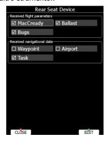
I dati sono divisi in due gruppi; parametri di volo e navigazione. Se il parametro è selezionato sarà automaticamente ricevuto dal secondo dispositivo.
