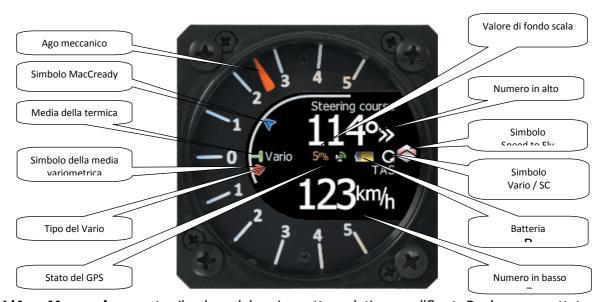
**L'Ago Meccanico** mostra il valore del vario, netto, relativo o sollfhart. Puo' essere settato indipendentemente in modo Vario o SC. La scala stampata puo' essere scelta nella scala +/- 5 oppure +/- 10. la scala in software puo' essere scelta per 2.5, 5, o 10 m/sec oppure 5,10,20 nodi oppure 500, 1000 , 2000 fpm.
