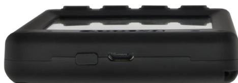
Sur le côté haut du boîtier, vous trouverez le connecteur micro-USB. Il est utilisé pour charger NANO4 et transférer les données. Le bouton POWER est juste à côté.
