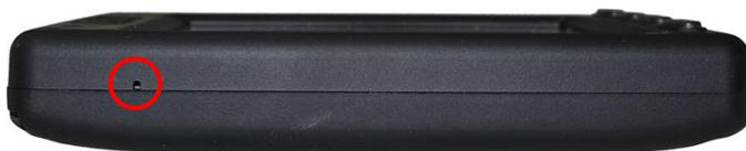
Du côté gauche vous disposez d'un petit trou incorporant le bouton de reset. En cas de nécessité, utiliser une aiguille pour atteindre le bouton de réinitialisation. En usage normal ce bouton ne devrait pas être utilisé.
