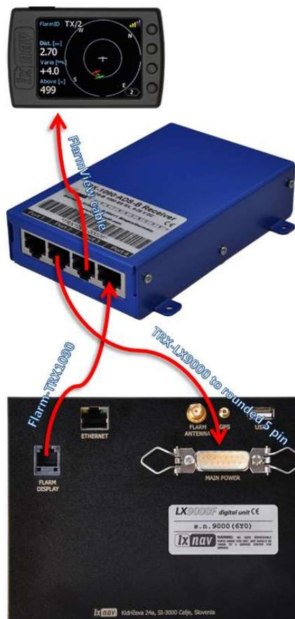
Ziehen Sie das Verbindungskabel zu einem eventuell vorhandenen Flarmdisplay am Display ab und stecken das freie Ende in der Port 4 des TRX1090. Verwenden Sie das Kabel LX80XX/LX90XX-TRX (nicht im Lieferumfang!) und verbinden damit Port 2 des TRX mit dem PC-Port (5pol Binder, rund) des LX80XX/LX90XX. Ein externes Flarmdisplay verbinden Sie mit Port 3 des TRX-1090.
