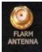
Für einen optimalen Flarmempfang müssen RF-Antennen senkrecht stehen und soweit wie möglich von metallischen Teilen, Kohlefaser, Kabeln und Instrumenten weg. Gute Erfahrungen wurden mit Flarm Antennen im Leitwerk gemacht, sofern dieses nicht aus Kohlefaser ist.
