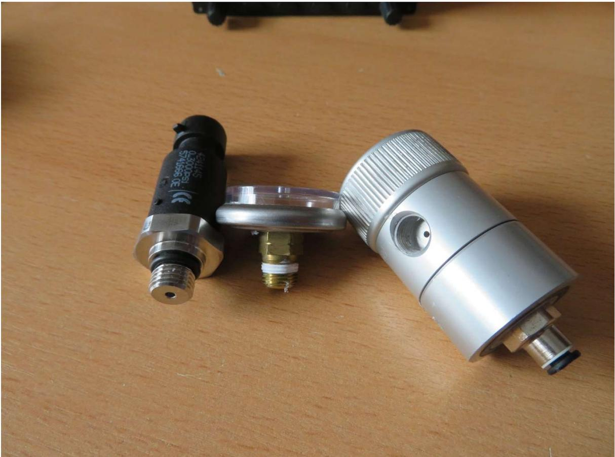
Der Sensor (links) wird anstelle der mechanischen Anzeige (Mitte) in den Druckminderer (rechts) geschraubt. Für den Europäischen Druckminderer ist ein Adapter erforderlich: SAE-4 (F) auf 1/8 NPT-M (nicht im Bild). Dichtung mit Teflonband an den Gewinden.
